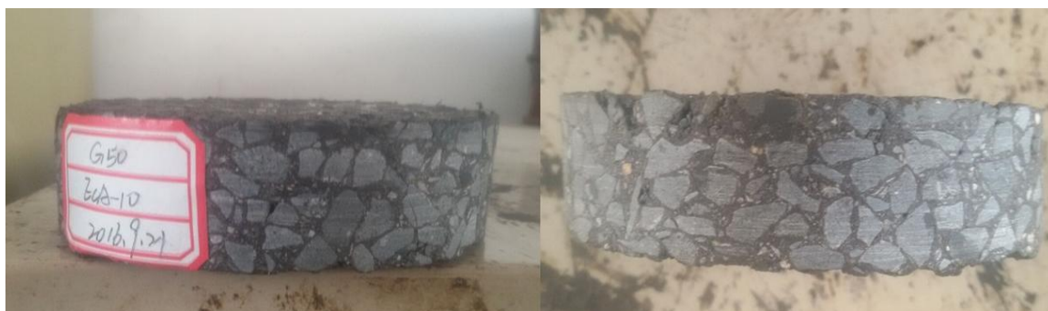
图C.6 钻芯取样照片
